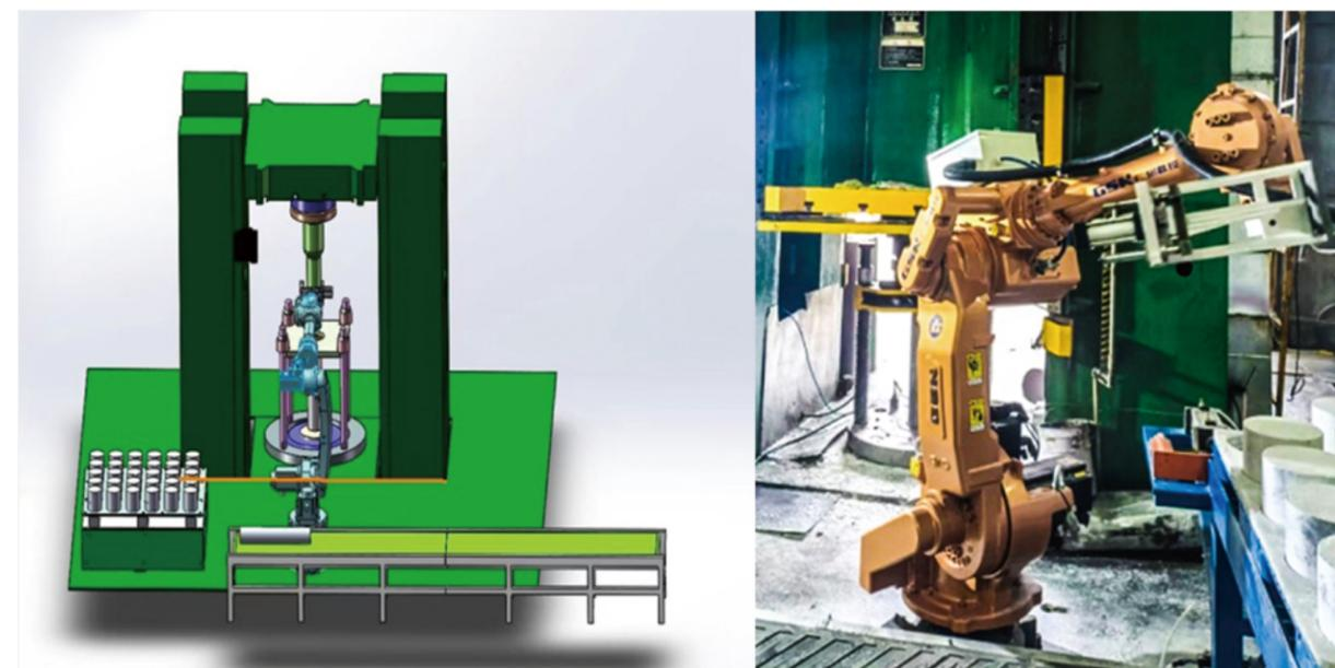
此这台机械手的载荷至少 30Kg。型号决定机械手的价格，项目人员首先咨询 ABB 进口机型厂商，该机型裸机报价 30 多万元且受疫情影响缺货。于是项目人员开始调研国产机型，咨询了多家国产品牌，最后选择了性价比和稳定性比较高的某厂家机械手，相比 ABB 进口机型，单台设备节省约 10 万元，且截至目前，该型号设备运行稳定，未出现问题。
