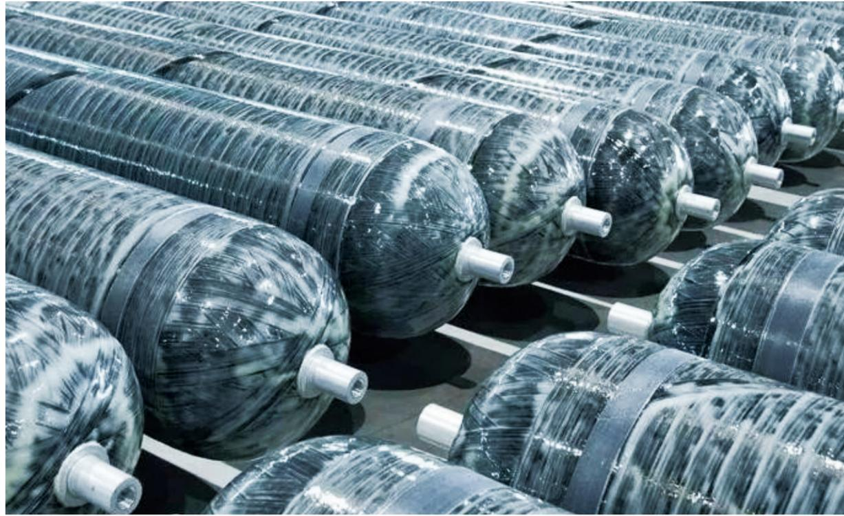
市场提供 200 ~ 350bar 的容器，并将于 2022 年将产品组合扩展到含 450 ~ 500bar 的容器。正如 UAC 的 CEO Øyvind Hamre 所说，玻璃纤维增强聚合物（GFRP）的容器具有与钢容器一样的成本支出，但重量却降低了 70%。而与 CFRP 容器相比，虽然 GFRP 容器要重一些，但却降低了 50% 的成本支出。
