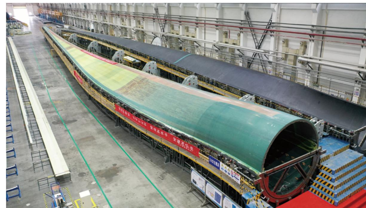
2021年9月1日，中复连众首支百米级大型海上风电叶片在连云港叶片生产基地成功下线。该叶片长102米，采用碳纤维主梁、叶根预制和后缘辅梁预制等全新界面融合技术，有效地缩短了叶片生产周期，提高了质量可靠性。
